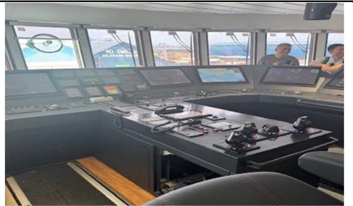
Fig 2: CSOV control room
